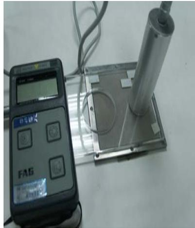
大面積與小面積  $\alpha / \beta$  污染偵檢器校正
